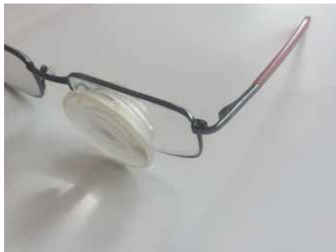
Två linser i kombination med antireflexbehandling på alla fyra ytorna ger minsta möjliga optiska fel.
