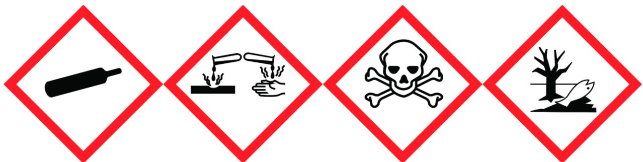
Abbildung 16: Die Gefahrenpiktogramme GHS04, GHS05, GHS06 und GHS09 (von links nach rechts)
