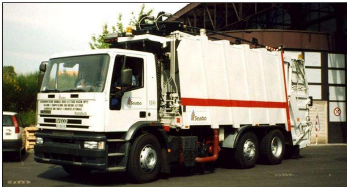
**Bild 20** Abfallsammelfahrzeug mit Stromabnehmer für O-Bus-Fahrleitung in Bologna [35]
