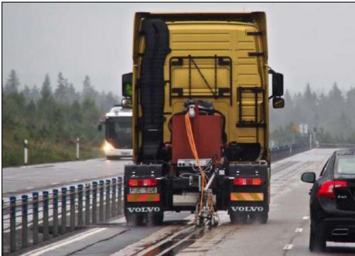
**Bild 90** Versuchsanordnung für ein Stromschienensystem für Lkw [61]
