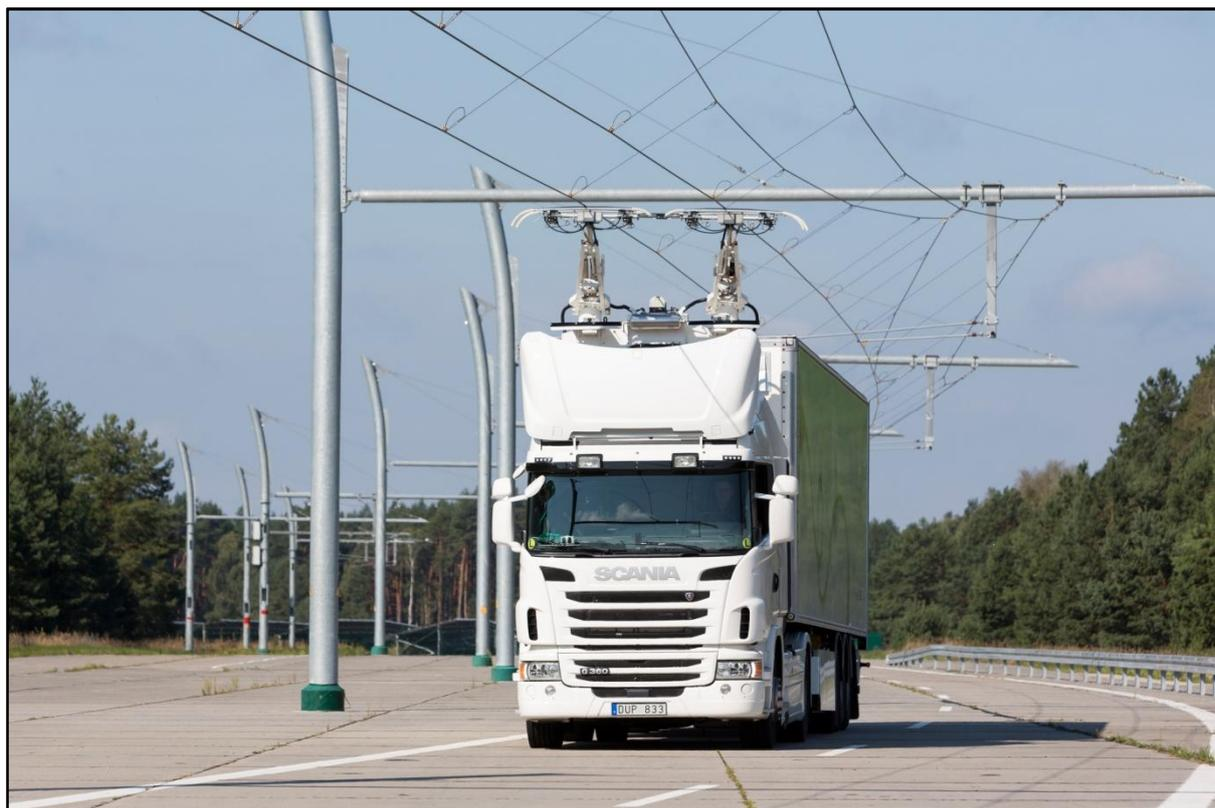
**Bild 57** Windschiefe Fahrleitung mit kurvenförmiger Fahrdrabtführung
