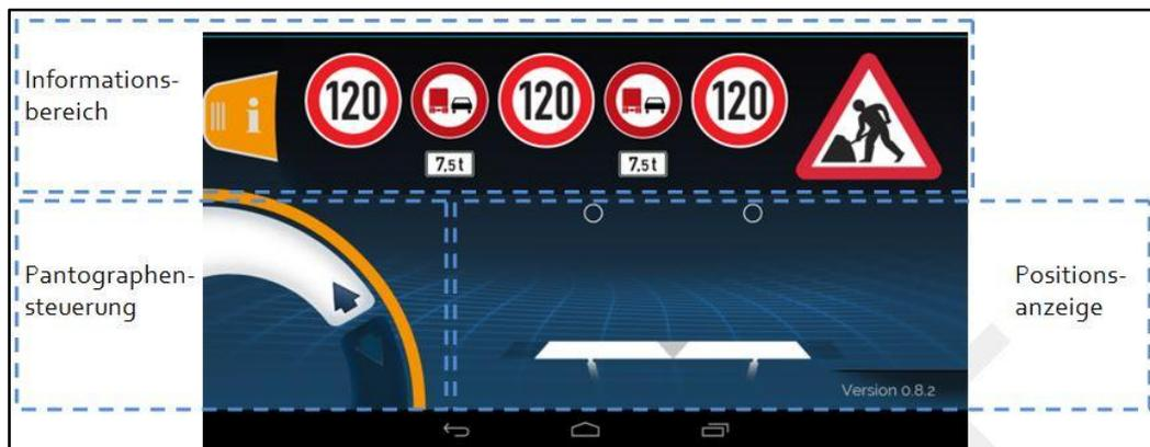
**Bild 27** Neu gestaltetes Bedienfeld zur Stromabnehmersteuerung (DLR [12])
