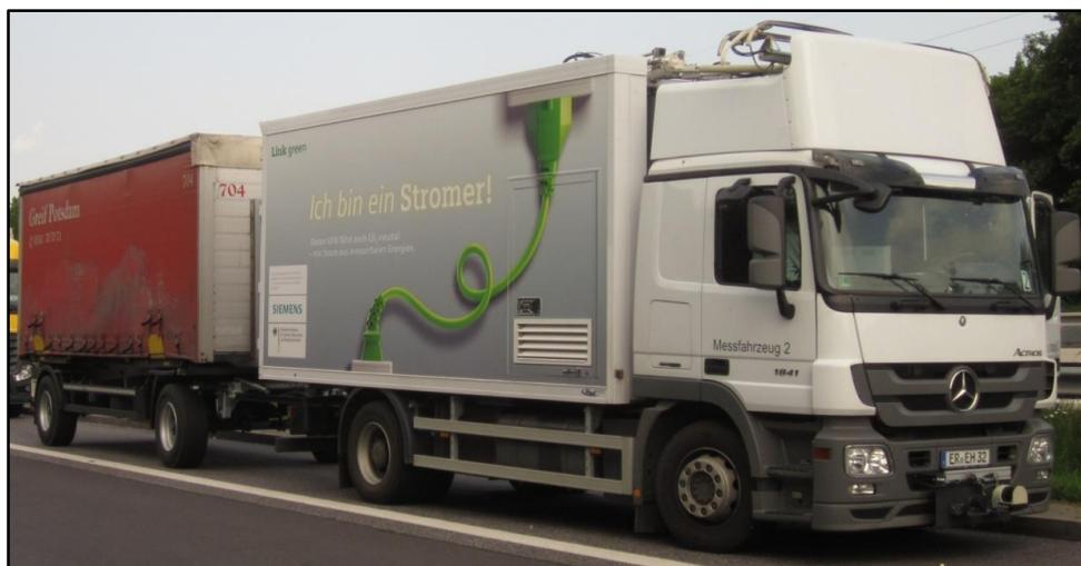
**Bild 80 Lkw-Zug für Langstreckenfahrten im dieselektrischen Betrieb**
