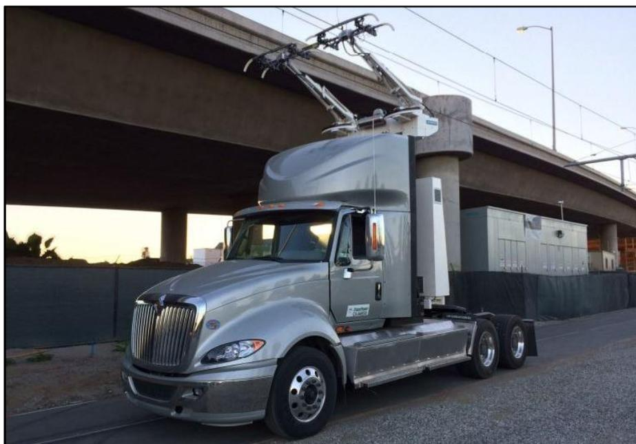
**Bild 92 Amerikanischer eHighway-Truck für den Betrieb bei L. A. auf der Versuchsstrecke**
