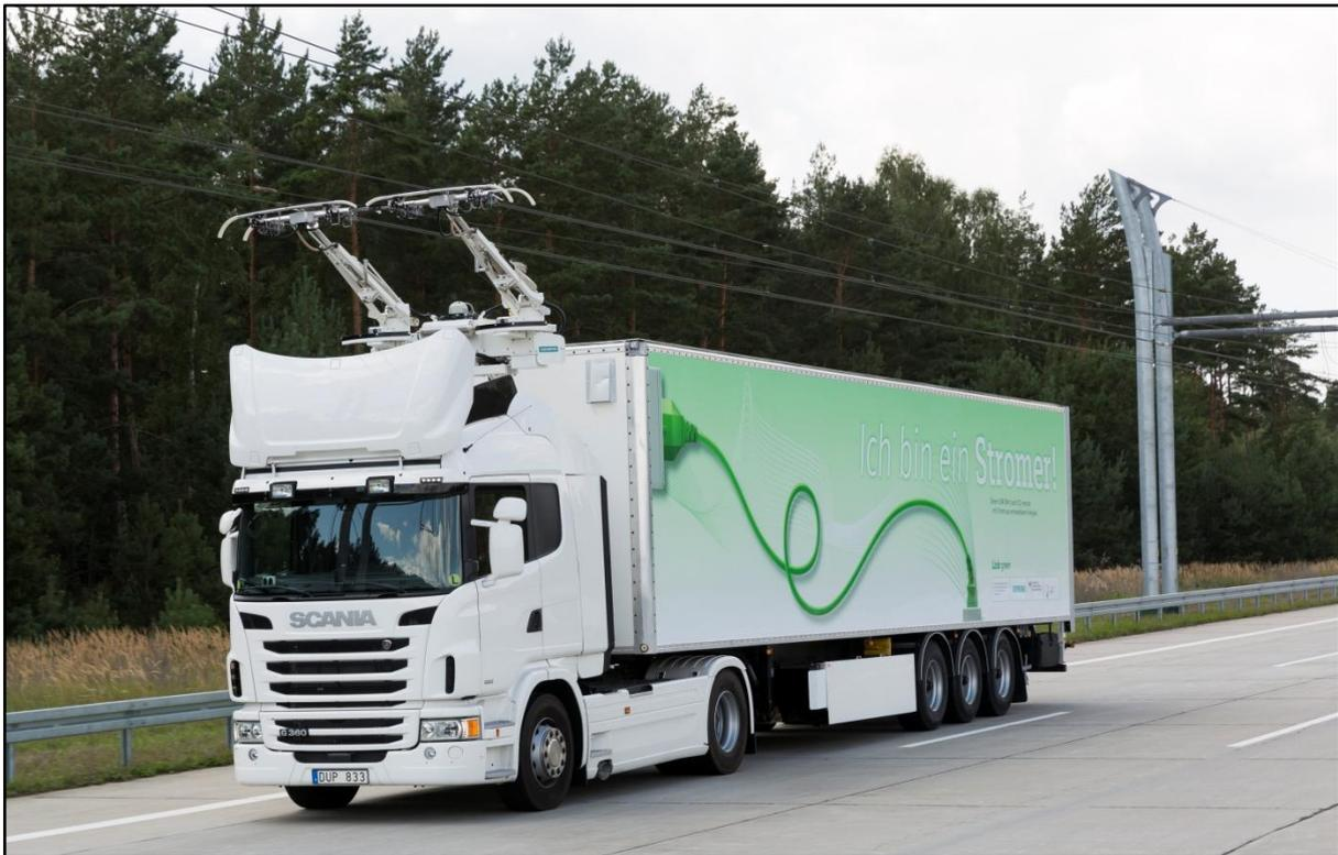
**Bild 38** Hybridisierte Sattelzugmaschine mit Auflieger auf der Versuchsanlage
