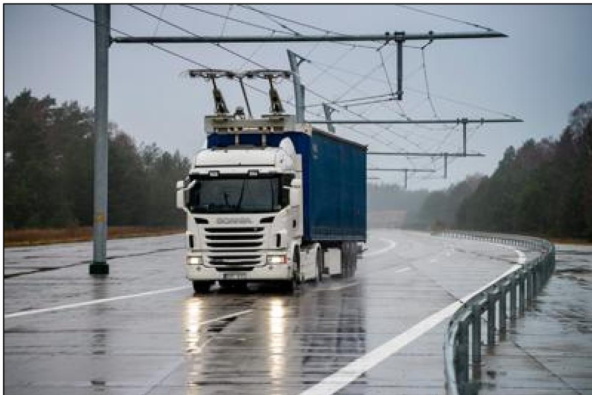
**Bild 4** Kurvenförmiger Verlauf von Fahrleitung und Fahrbahnmarkierung (© Scania)
