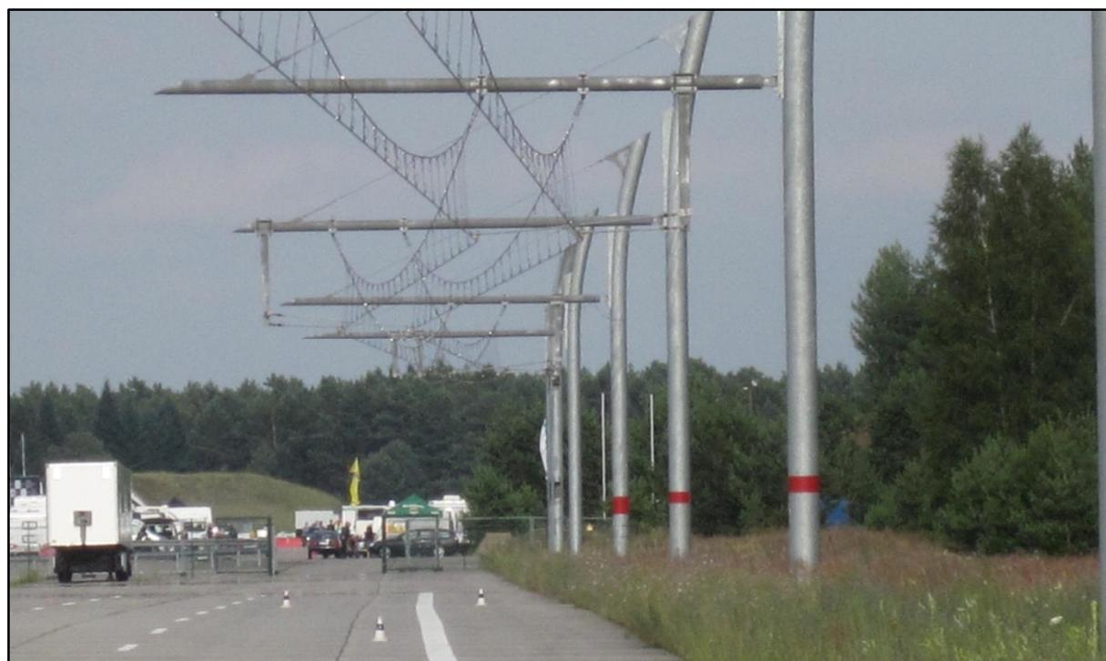
**Bild 58** Kurvennachbildung mit Zick-Zack-Verlauf der Fahrleitung
