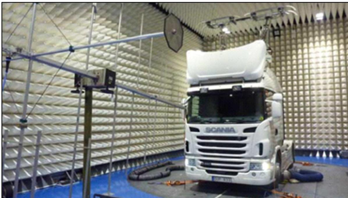
**Bild 70** Scania-Sattelzugmaschine in der EMV-Messhalle
