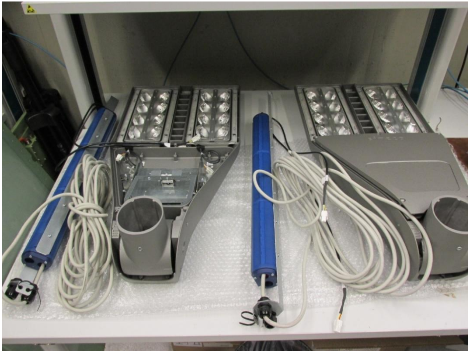
Abbildung 9: Radarsensor integriert in LED-Leuchte SL10 von Osram (Labormuster)
