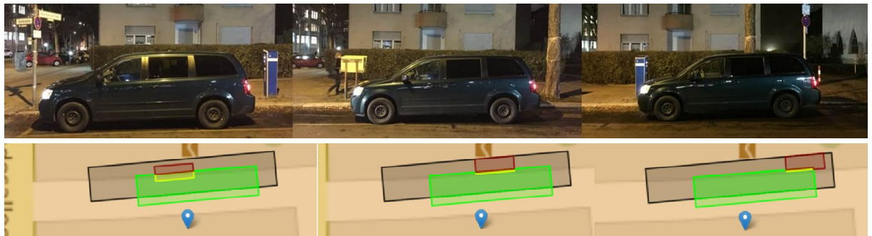
Abbildung 55: Vor-Ort-Begehung: oben: Real-Situation, unten: Anzeige der APM-Oberfläche: plausible Verortung des erkannten Fahrzeugs
