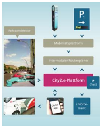
Abbildung 62: Übersicht der Komponenten und des Datenaustausches. Das vom DFKI entwickelte Prognosemodul ist mit dem Block "P(frei)" dargestellt. Es kann durch die Projektplattform Anfragen an das Sensorsystem stellen und es bekommt Vorhersageanfragen über die Plattform (Quelle: VMZ Berlin).
