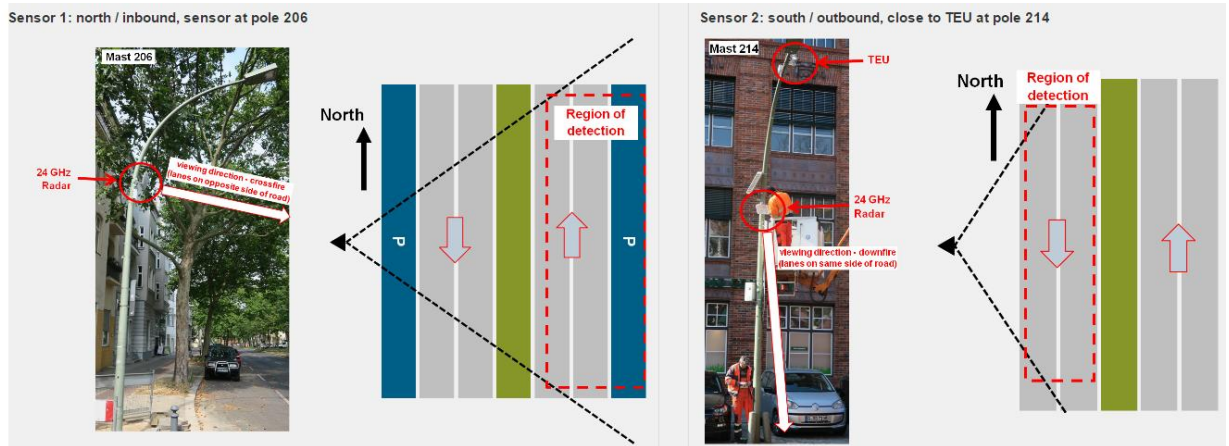
Abbildung 13: Installation der Radarsensoren zur Ermittlung der Verkehrsdichte
