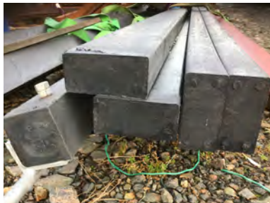
Plast drager/bjelke med innlagt stål
