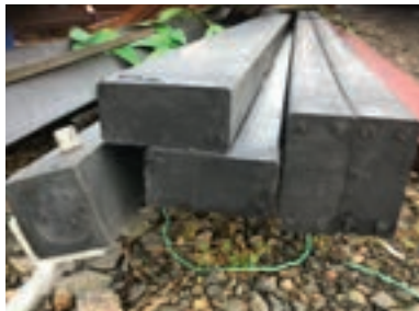
Plast drager/bjelke med innlagt stål
