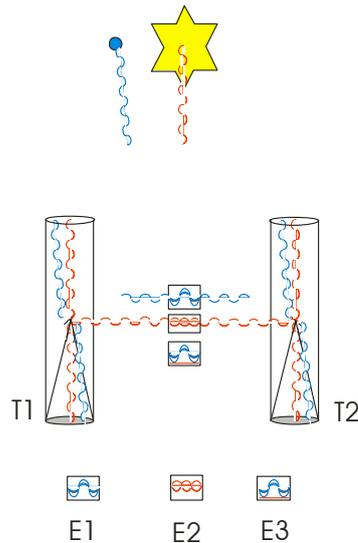
Los haces de luz de T1 y T2, procedentes de la estrella, se juntan, sin embargo con una diferencia de media longitud de onda. Pero esto significa que interferirán destructivamente y, por tanto, se extinguirán mutuamente. El observador en E2 ("E" de "Ojo") ya no ve la luz de la estrella o la ve muy atenuada. Las dos ondas destructivas se nivelan entre sí y se muestran con una línea recta roja. Así, la estrella apenas es visible o deja de serlo.
