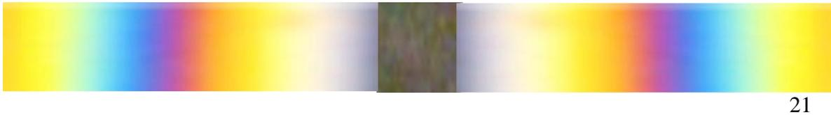
Bei extrem präziser Ausrichtung wird er schließlich so breit, dass er den Durchmesser unseres Spiegels um ein Vielfaches übersteigt. Wir können den Spiegel dann so einstellen, dass seine gesamte Oberfläche wahlweise jeweils mit einer einzigen Interferenzfarbe gefüllt wird. Dies wird im Folgenden dargestellt (22).
