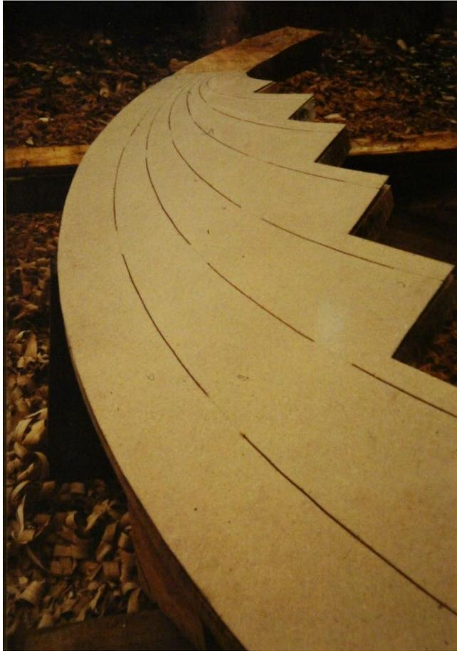
*Anschliessend wurde die Abtrappung ausgearbeitet, so dass die anzusetzenden Planken eine Anflansungsfläche von etwa 4 cm aufwiesen.*
