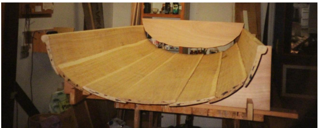
*Danach durfte das Holz gerne trocknen, bis der ganze Wagenunterbau praktisch fertig war. Somit war gewährleistet, dass nach dem späteren Zusammenbau des Wagenkastens keine Risse entstehen konnten.*
