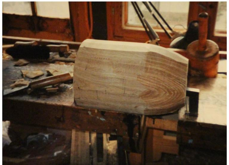
***Wie man auf diesem Bild sehr gut erkennen kann, wurde schon vorher für die Wagenachse erstmal ein Richtungsloch von 14 mm Ø Durchmesser durch den Grobling gebohrt. Das sicherte die Mitte des zukünftigen Achsenloches dessen Durchmesser dann später 65 mm betrug.***
