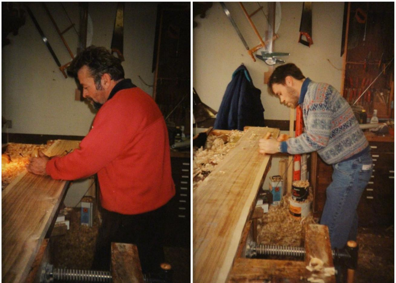
*Mit der fertigen Ausarbeitung der einzelnen Planken half mir unser jüngste Sohn Claus. Die unterste Bodenplanke musste wegen des grossen Breitenmasses aus einem Stück in voller Breite des einen Stammes gearbeitet werden.*
