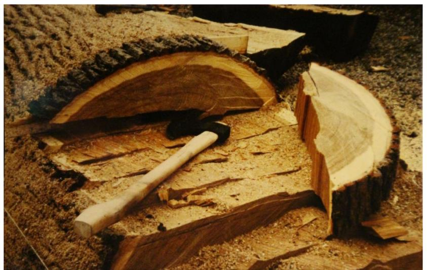
*In gewissen Abständen wurden mit einer Axt Einkerbungen geschlagen, (bei mir die Kettensäge) die bis ein paar cm über den Kreidemarkierungen reichten. Hiernach keilte man einfach die dazwischen-liegenden Blöcke weg. So entstand eine dicke Bohle mit dem Kern in der Mitte. Die Jahresringe erzählten uns, dass so eine Eiche mit 110 cm Ø ein Alter von 247 Jahren aufweisen kann.*
