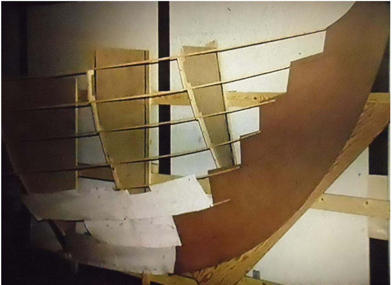
*Das zweite Model stand also Pate für den entgeltigen Aufriss, da alle Masse jetzt in etwa vorhanden waren.*
