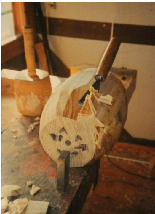
*Stöpsel, die in die Bohrung eingeführt werden. Der Mittelpunkt ist schnell gefunden, man spannt die Nabe zwischen Mitbringer und Pinoldock, und bringt das Ganze in Bewegung. Der Drechselvorgang beschränkt sich alleine auf die genaue Auswuchtung und Ausarbeitung der beiden Wulste. Eine Arbeit, die, wegen des grossen Gewichts keine grosse Mühe macht.*
