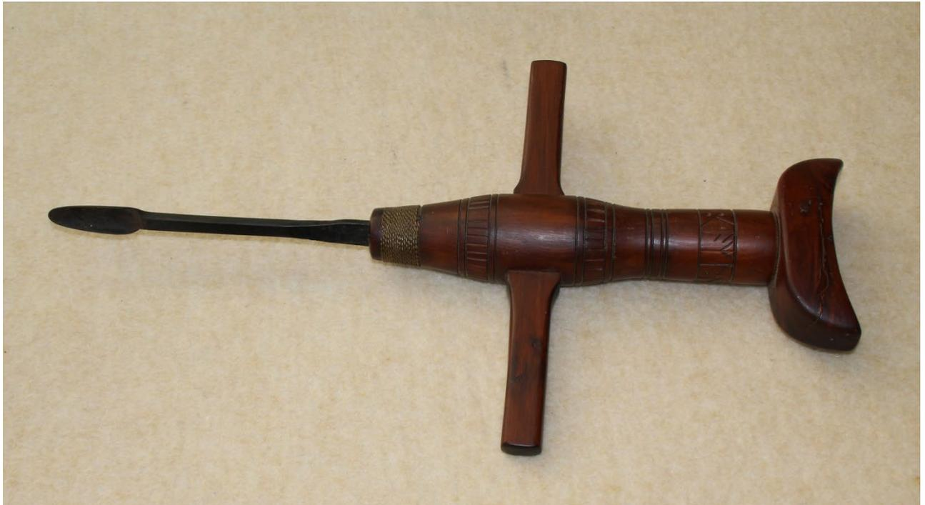
*Ein Eisen zum Ausheben von Nuten beim Hausbau.*
