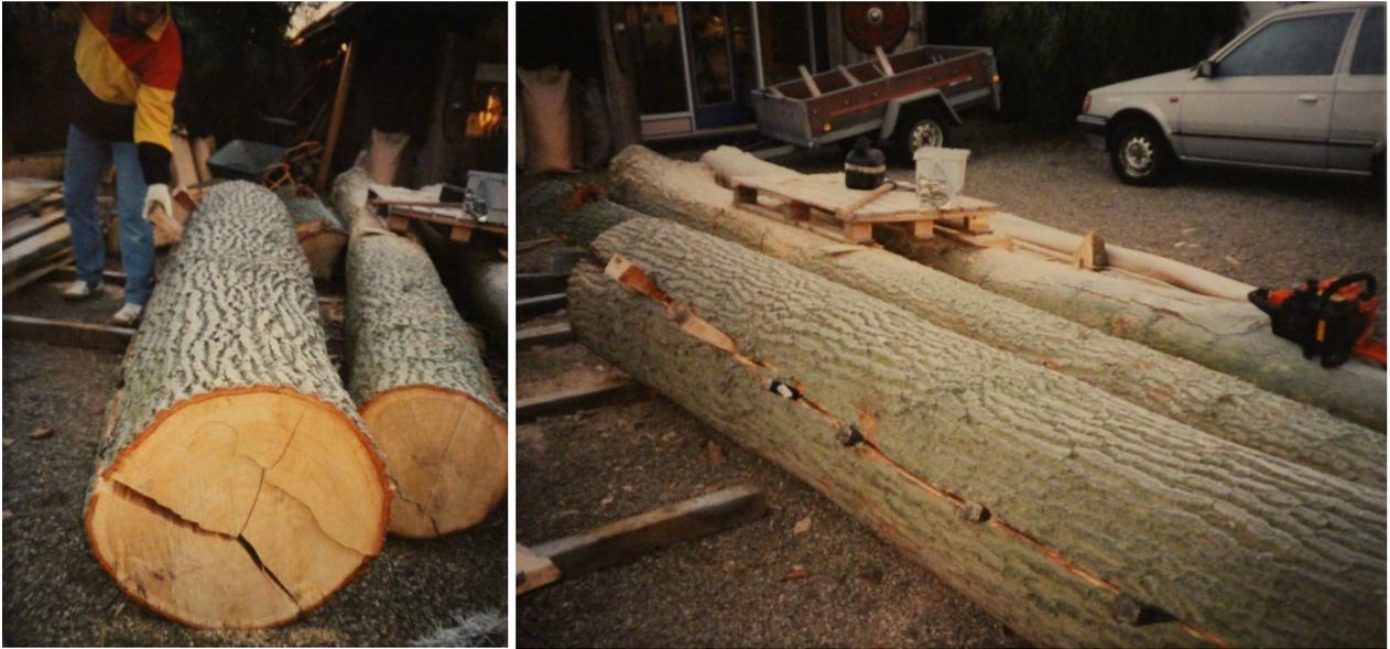
***Die erste Aufgabe für den Wagennachbau war, die Seitenbretter für den Wagenkasten aus den Stämmen zu spalten und zu bearbeiten, damit diese, während der anstehenden Arbeiten für den Unterbau, trocknen konnten. Sieben Seitenbretter und zwei Giebelstücke wurden hierfür benötigt, und sollten auf die wohlbekannte Klinkerbauweise zusammengefügt werden. Hierfür hatte ich zwei Eichenstämme zur Verfügung, die über dem Kern in Keilförmige Stücke gespalten wurden.***
