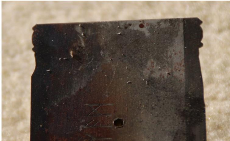
*Auch die Verschönerung dieser Flächen mussten vor dem Zusammenbau stattfinden. Für die kleinen Kreise hatte er einen kleinen Handbohrer, und für eingekerbte Linien ein dreieckiges Eisen, dass vorne schräg angeschliffen war. Waren alle diese*
