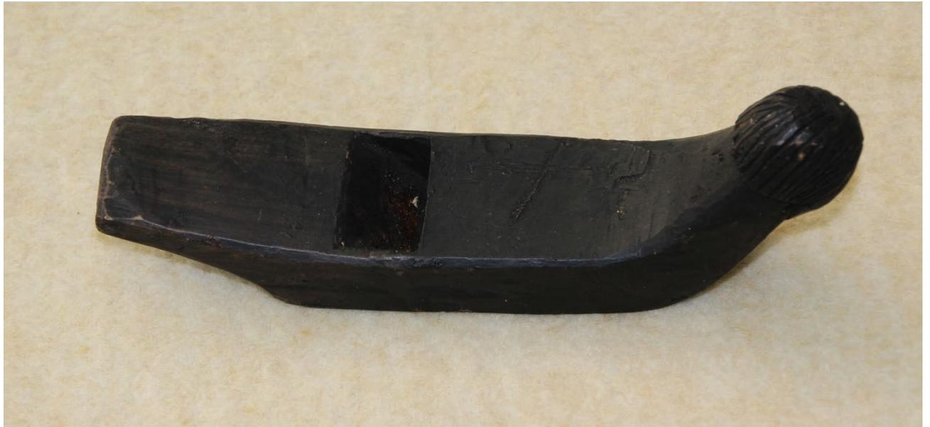
*Um das Eisen genau und fest zu platzieren, setzt man den Hobel auf ein Stück Holz mit glatter Oberfläche, und schlägt mit dem Hammer auf das hintere Ende. Bei diesem Vorgang drückt sich die Schneide schonend fest in die Nut des Maules. Es ist erstaunlich, wie fest das Eisen in seinem Lager sitzt, jedoch ist die Wahl des Materials für diesen Hobel von entscheidender Bedeutung. Ein weicherer Material als das Eibenholz würde dieser Belastung nicht standhalten.*
