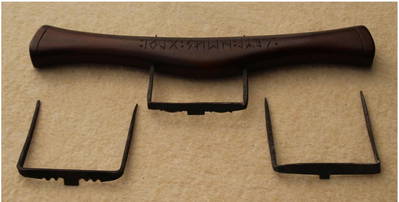
*Auch Ziehhobel genannt. Er hat in der Mitte einen Anschlag und auf beiden Seiten ein eingearbeitetes Negativprofil. Durch mehrmaliges Ziehen dieses Werkzeuges, die Linienführung als Anschlag benutzend, bekam er sein Profil. Die auslaufenden Spitzen wurden mit einem Hohleisen geformt.*
