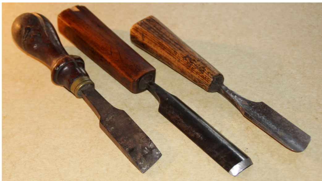
Gammelt værktøj til trædrejning, som er skæftet på forskellige måder.
