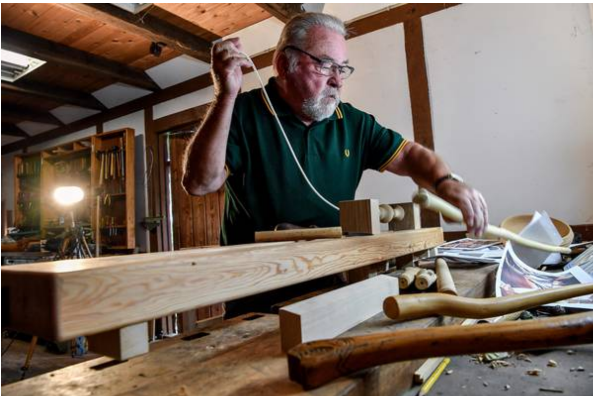
Drejebænken med flitsbue er den tidligste drejebænk i menneskehedens historie. Den stammer fra de sydlige egne og blev blandt andet brugt i Ægypten omkring år 500 f.v.t. Foto: Timo Battefeld Foto: Timo Battefeld
