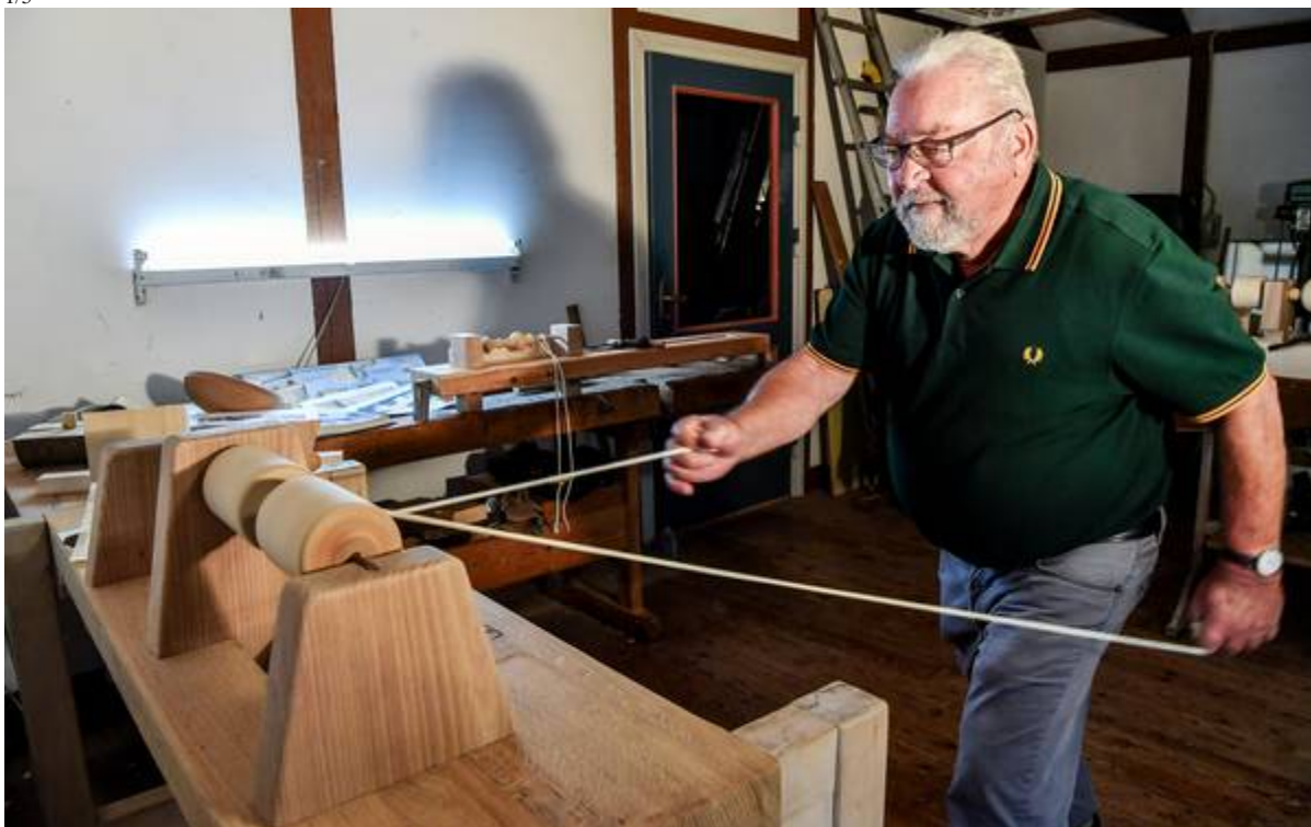
Karl-Heinz "Carlo" Gloy demonstrerer, hvordan den mest moderne af oldtidens trædrejere bliver holdt i gang med snor og i dette tilfælde armkraft. Foto: Timo Battefeld
