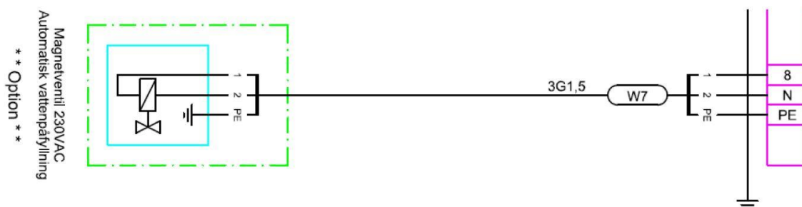
FIGUR 2 VISAR EN ÖVERBLICK AV AUTOMATISKA PÅFYLLNINGSSYSTEMET.
