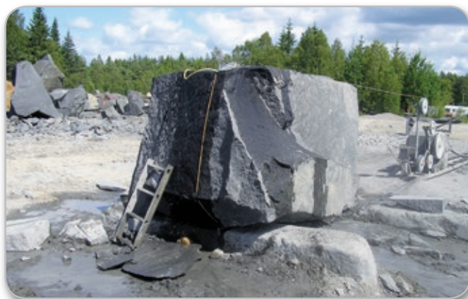
Den nya sågen, som delar blocket med hjälp av diamanter.
