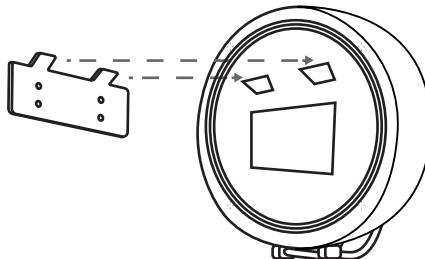
Montér vægbeslaget i vatter på en plan overflade. Hæng Wally på vægbeslaget.
