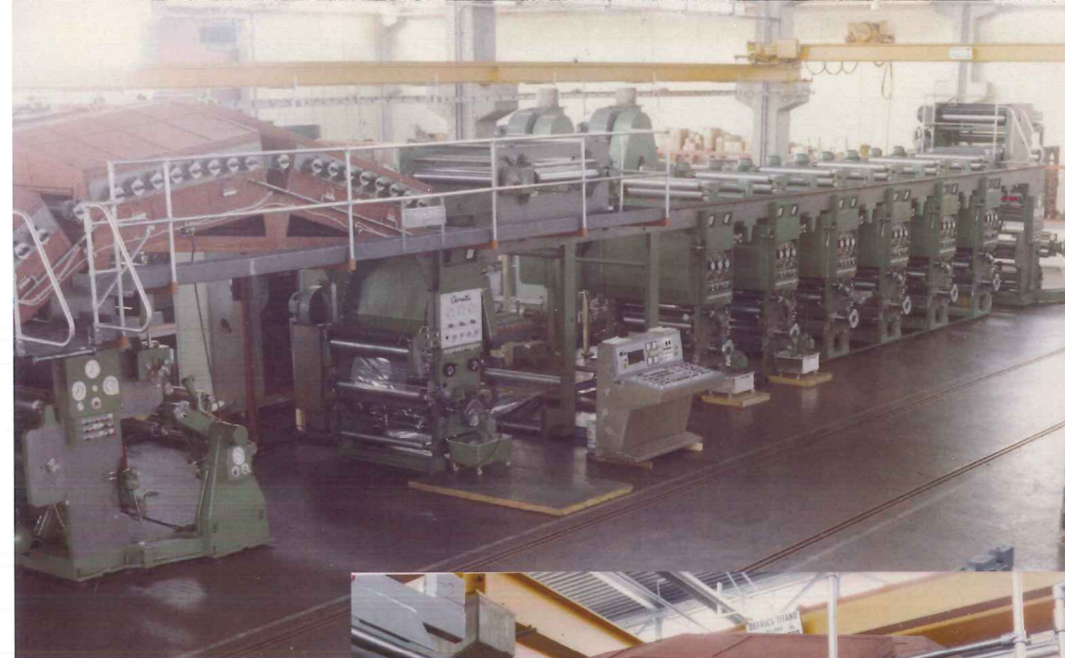
De Cerutti 5 waarop in 7 kleuren kon worden gedrukt. Rechts detailfoto van het droogkanaal dat zorgde voor het versneld drogen na drukken en lamineren
