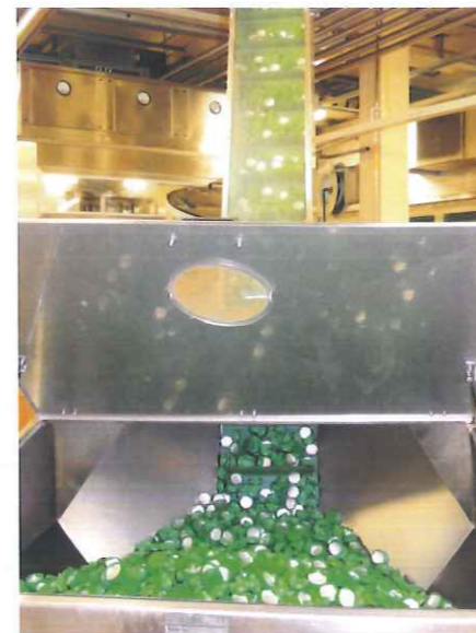
Flessendoppen gaan via een transportband omhoog naar de machine die ze gaat monteren op de flessen
