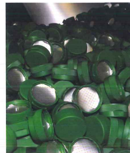
De doppen zijn voorzien van een zilverkleurig afsluitplastic dat de fles hermetisch van de buitenlucht af sluit
