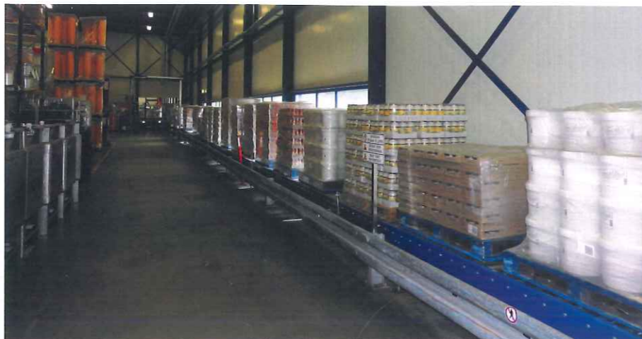
De hoofdrollerbaan die alle producten vervoert naar de laadplaats van de vrachtwagens
