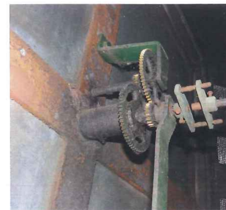
Deze tandraden zorgen er voor dat de beweging van de uurwerkstang wordt omgezet in de beweging van de beide wijzers van de klok
