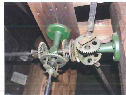
De overbrenging van de beweging van het uurwerk (de verticale stang onder in beeld) op de stangen voor de wijzers van de vier klokken
