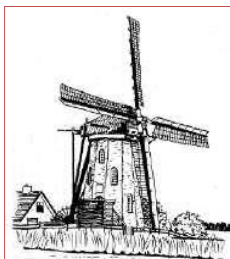
Figuur 3. Molentype dat Willem gebruikte: stenen grondzeiler bovenkruier.
