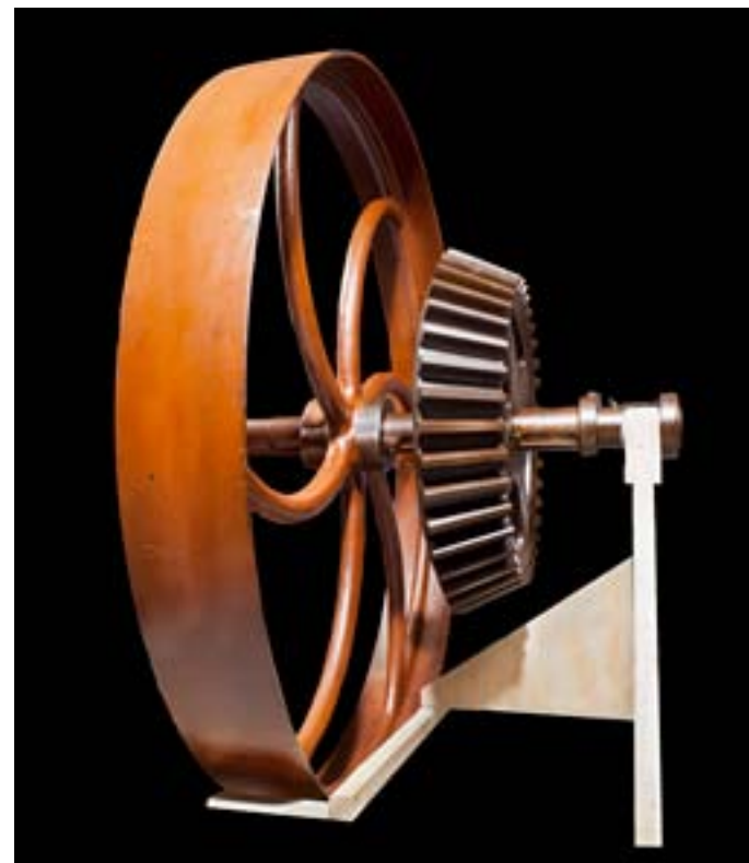
Fig. 2. | Svinghjul fra dampmaskine, produceret på maskinfabrikken Atlas, 1899. Danmarks Nyere Tid.
