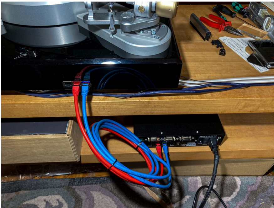
Strömboks: En ekstern strømforsyningsenhed forsyner de to motorer i Verona via separate CAT5-kabler. Strømforsyningsenheden genererer den nødvendige vekselstrømsspænding digitalt (Foto: B. Rietschel)
