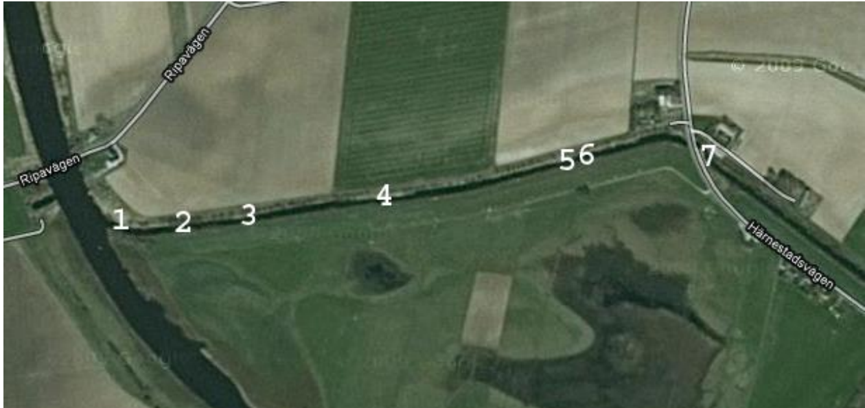
Figur 27. Karta över Graften med de sju mätpunkterna utsatta. Platserna valdes ut utifrån de observationer som gjorts vid inventeringen till fots för att kunna jämföra sträckor med olika stort motstånd i vattendraget. Punkt 2 var den del av Graften som misstänktes ha minst motstånd för vattnet och punkterna 1 samt 3-7 valdes för att de hade vass och andra hinder som misstänktes generera större motstånd. Bakgrundskarta: © Google Earth
