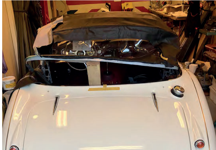
Ovan testas först suffletten på plats, innan den sedan monteras i bakkant. När detta är klart – med alla 36 clips på regnrännan – så är det dags för det spännande momentet att sträcka duken framåt för att fästa den i "framstocken". Man får bara en chans ... men lyckas man blir det som nedan!
