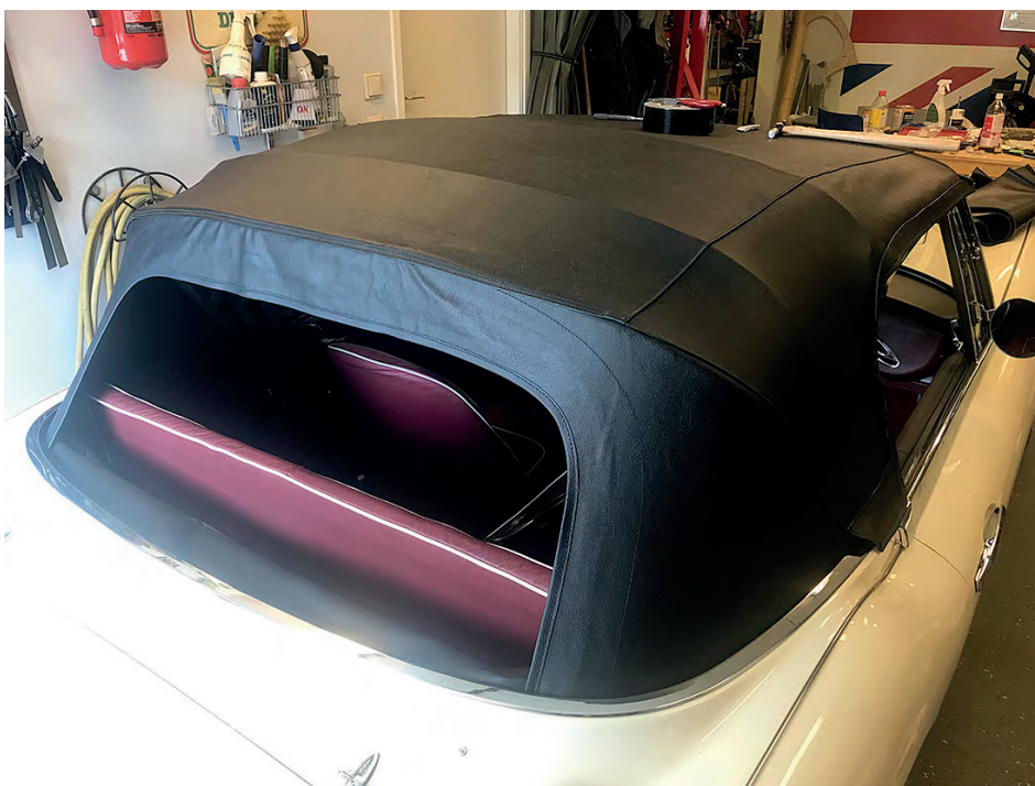
Ovan testas först suffletten på plats, innan den sedan monteras i bakkant. När detta är klart – med alla 36 clips på regnrännan – så är det dags för det spännande momentet att sträcka duken framåt för att fästa den i "framstocken". Man får bara en chans ... men lyckas man blir det som nedan!
