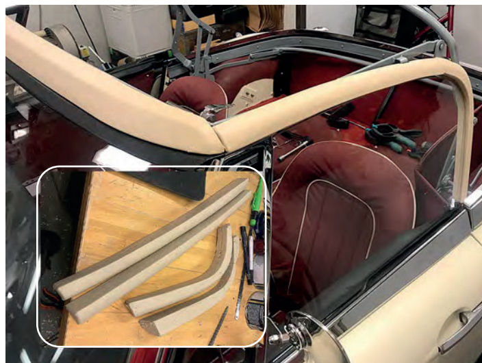
Till vänster: Aluminiumkepsen klädd med svart vinyl och framstocken på väg att få sin vit-beigea vinyl. Ovan provmontering av trädetaljer innan kädsl med vit-beige vinyl.
