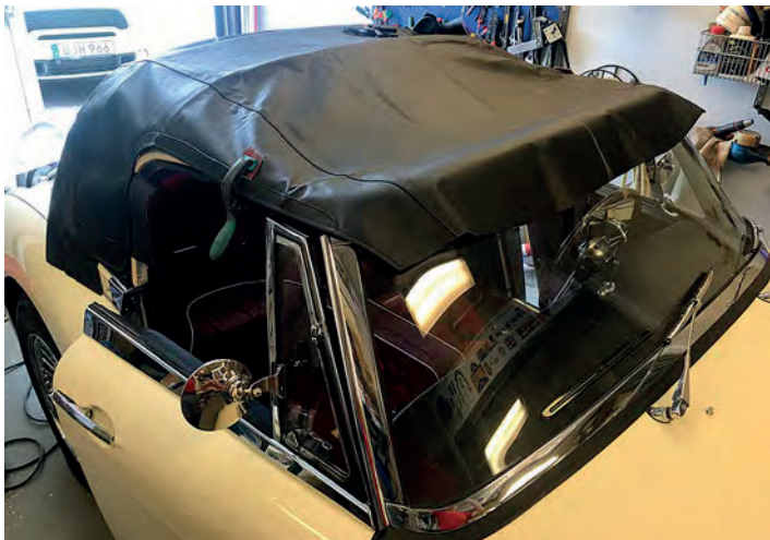
Ovan testas först suffletten på plats, innan den sedan monteras i bakkant. När detta är klart – med alla 36 clips på regnrännan – så är det dags för det spännande momentet att sträcka duken framåt för att fästa den i "framstocken". Man får bara en chans ... men lyckas man blir det som nedan!
