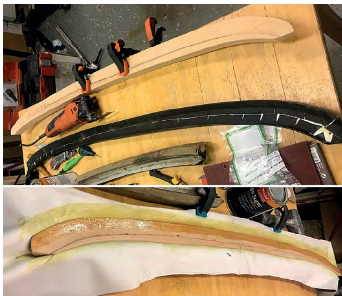
Till vänster: Aluminiumkepsen klädd med svart vinyl och framstocken på väg att få sin vit-beigea vinyl. Ovan provmontering av trädetaljer innan kädsl med vit-beige vinyl.
