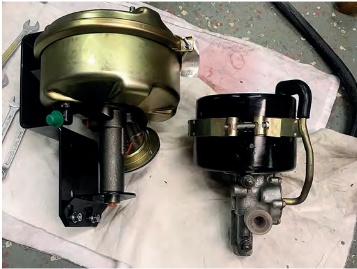
Ovan: Den nya servon till vänster. Något större ... Ratt med den nya trafikatorn på plats efter en hel del pillande. Nedan: O/D-problemet med den påsvetsade lösningen i infällda bilden.
