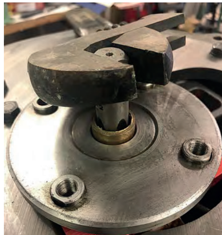
Bussningen ska ur! M20 gängtapp är verktyget, och då kommer den ur så här smidigt!
