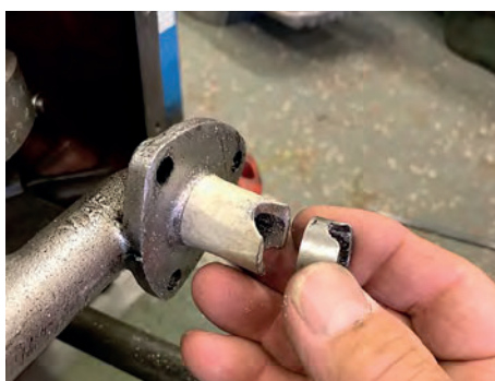
Olje pick-upen (till vänster) måste kortas när man använder aluminiumtråg, och silen måste plattas till lite.
