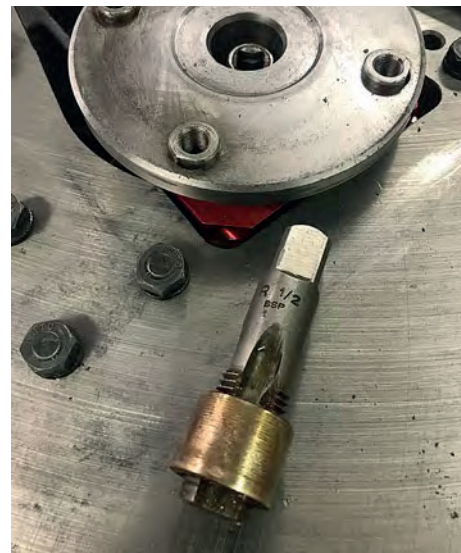
Bussningen ska ur! M20 gängtapp är verktyget, och då kommer den ur så här smidigt!
