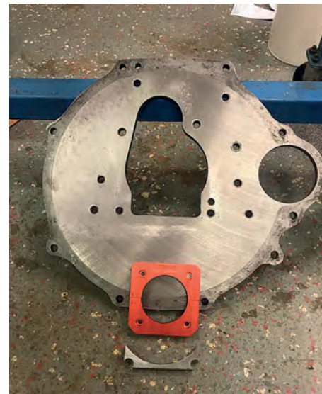
Bakre plåten modifieras för ny tätning av vevaxeln.
