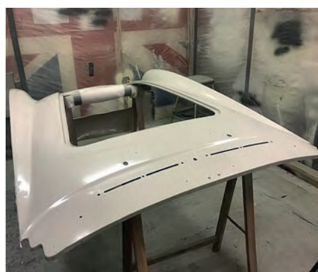
Frontshrouden rengjord och epoxigrundad. Blir ju nästan som nytt!
