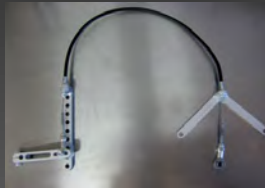
Sideways SU gaslänkage
