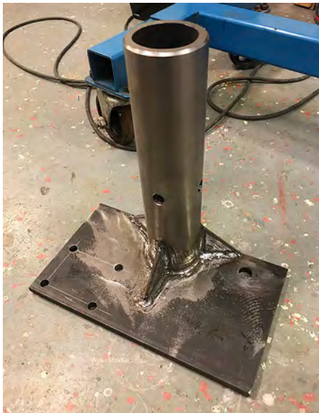
Nytt Helaeyanpassat fäste till motorstödet. Du ser det modifierade stödet på vinjettbilden.
