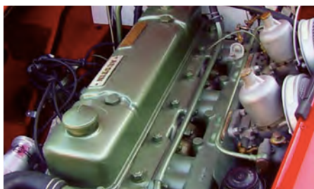
Tidig C-series 2912 cc med fyra ramlager.
