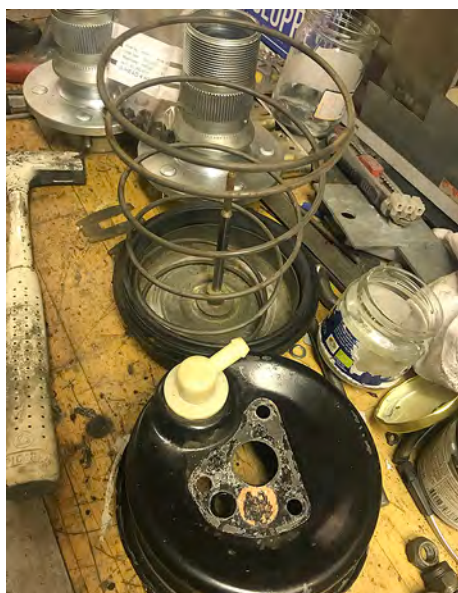
Ovan vacuumburken med fjädern åt fel håll! Nedan "slaktad" cylinder.
