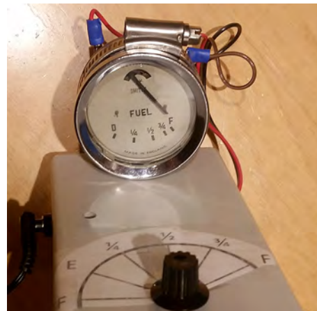
Mätinstrument anslutet till bränslemätaren.
