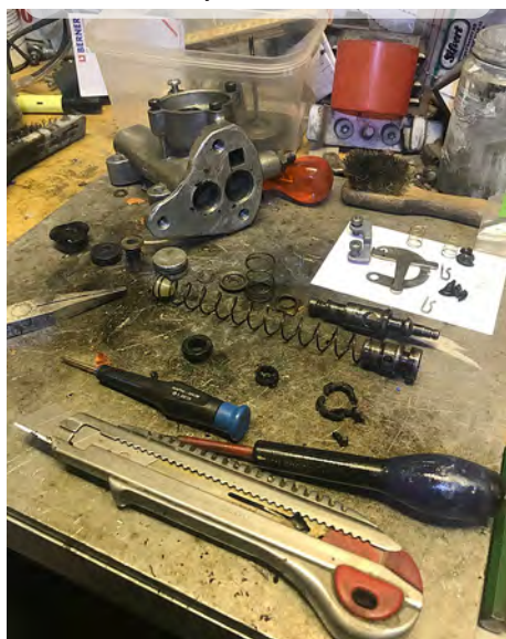
Ovan vacuumburken med fjädern åt fel håll! Nedan "slaktad" cylinder.
