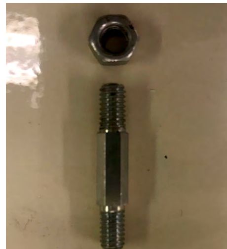
Montagedetalj för värmebläkt.
