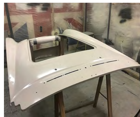
Frontshrouden rengjord och epoxigrundad. Blir ju nästan som nytt!
