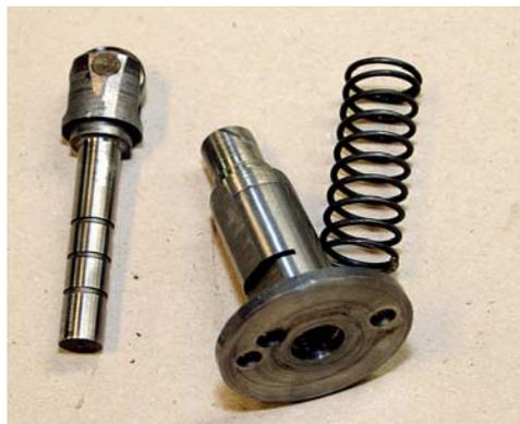
**2** Pumpens delar. Pumphuset har ett urtag som ska vändas mot backventilen, kolven är assymetrisk och den avfasade delen ska vändas mot överväxelhuset.
