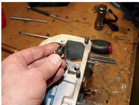
**8** Släpp ned kulan i hålet för backventilen, följ efter med sätet och fjädern och skruva dit pluggen som håller allt på plats. Glöm inte att smörja delarna innan montering.
