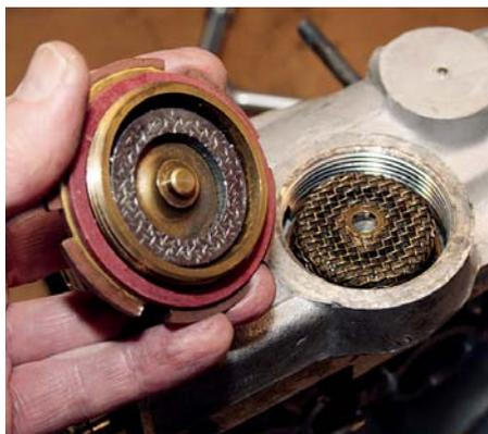
**6** Efter att pumpen har skruvats fast med två spårskruvar är det dags att montera en rengjord sil och sedan skriva dit bottenpluggen med en ny fiberbricka som tätning.
