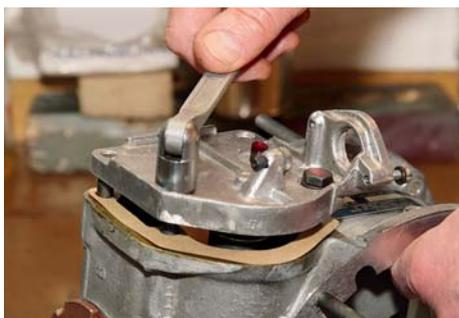
**16** Använd en ny packning och montera locket över ackumulatorm. Dra skruvarna korsvis så att fjädern komprimeras.
