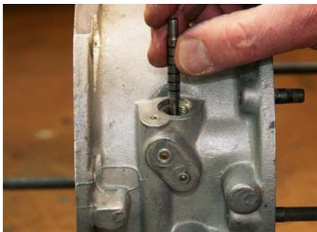
**10** Sedan är det bara att ha på några droppar olja på delarna och släppa ned ventiltillröret följt av kulan, sätet och fjädern. Avsluta med att skruva dit pluggen.
