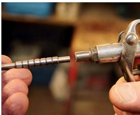
**9** Blås rent manöverventilens inhåliga ventiltillrör och kontrollera noga att det inte är igensatt.
