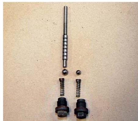
**7** Överväxels manöverventil till vänster och pumpens backventil till höger. Manöverventilens rör är ihåligt. Gör rent och kolla noga att det inte är igensatt.
