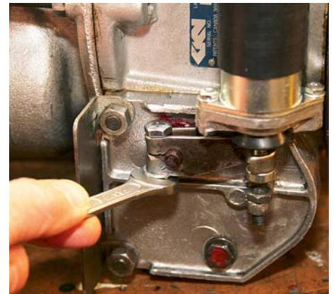
**25** ... anslut solenoiden till ett batteri. När solenoiden står i hållläget justerar man hävarmen så att den vilar mot huvudet på solenoidens dragstång och drar fast klämskraven.
