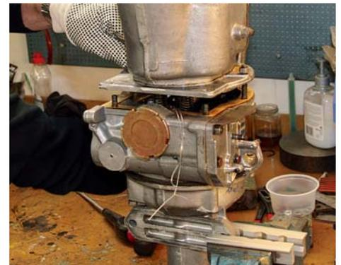
**23** På en A-typ med lösa fjädrar är det enklast att montera överväxeln i ett skruvstycke och sedan ställa växellådan ovanpå överväxeln. Dels behöver man inte hålla ordning på fjädrarna, dels hjälper växellådans tyngd till vid monteringen.
