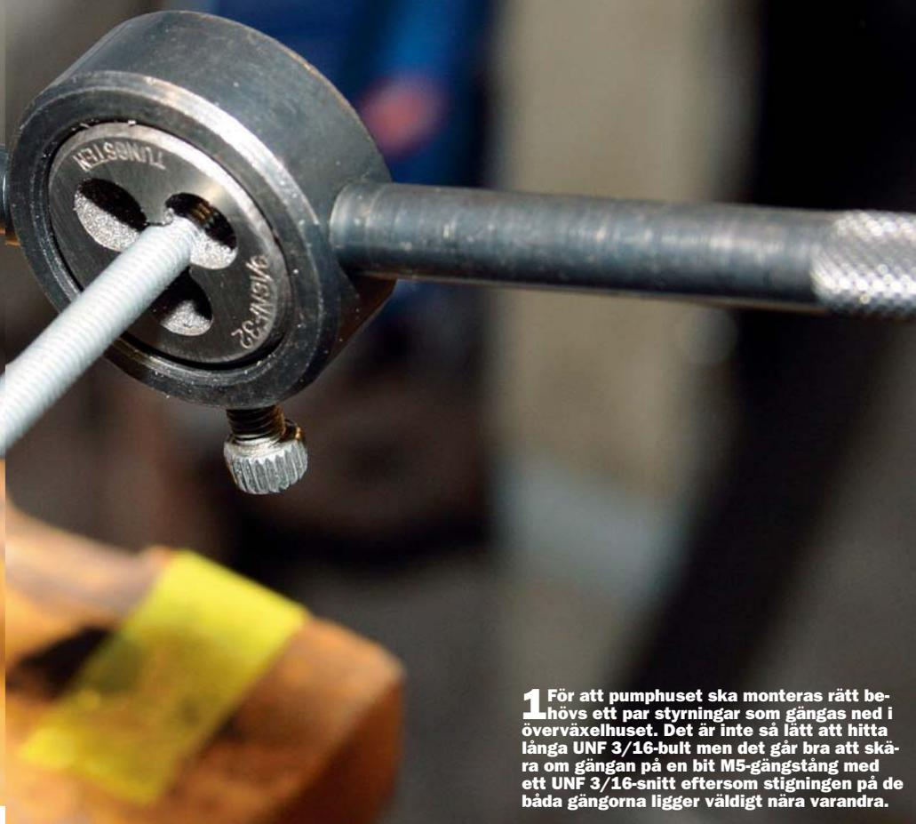
**1** För att pumphuset ska monteras rätt behövs ett par styrningar som gängas ned i överväxelhuset. Det är inte så lätt att hitta långa UNF 3/16-bult men det går bra att skära om gängan på en bit M5-gängstång med ett UNF 3/16-snitt eftersom stigningen på de båda gängorna ligger väldigt nära varandra.
