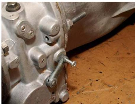
**24** När solenoiden är monterad ska hydraularmen som manövrerar överväxeln justeras. För in en borr eller en skruv som är 3/16 tum genom hålet i armen och in i motsvarande hål i huset och ...
