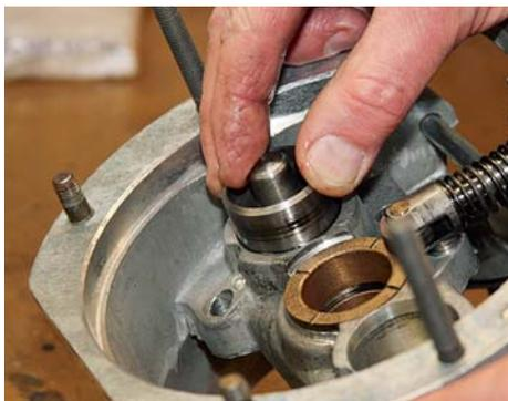
**12** Smörj kolvarna och cylindrarna och montera kolvarna på sin plats.
