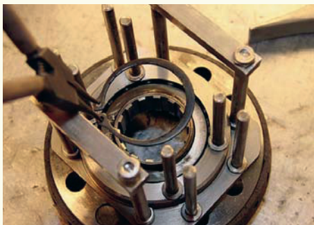
14 För att lossa kopplingskonan från hållaren börjar du med att ta bort låsringen på kopplingskonan.
