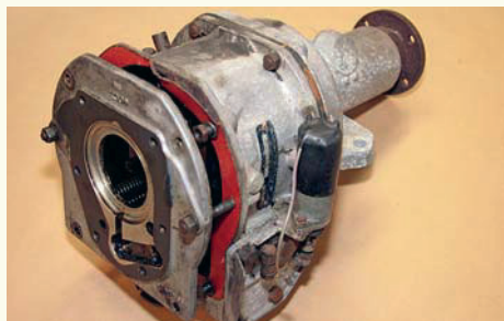
13 Överväxelenheten demonterad från lådan. Längst fram adapterplattan som ser olika ut beroende på vilken låda överväxel ska sitta på, i mitten den del som hydrauliken finns i och längst bak den del som rymmer planetväxeln och kopplingskonan.
