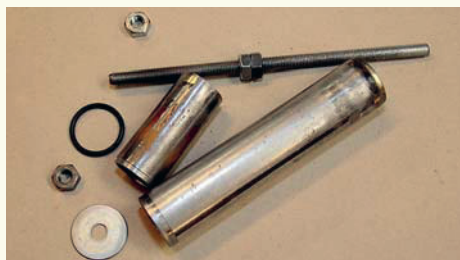
11 Materialet som går åt för att tillverka en avdragare för att dra ut ackumulatorm på en A-typ.
