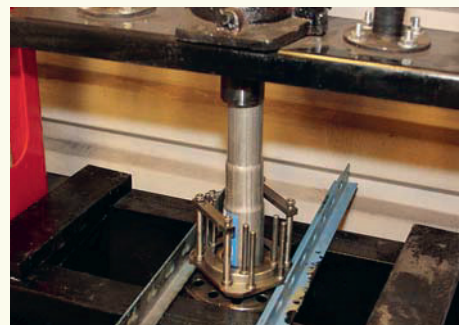
15 Pressa sedan loss kopplingskonan från lagerhållaren.
