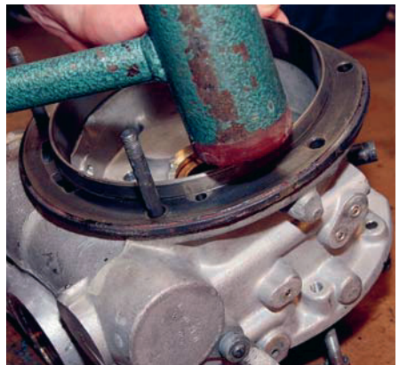
23 ... det främre huset så att konan öppnar bakåt. Slå några lätta slag på ringen med en mjuk klubba så att den sätter sig ordentligt.
