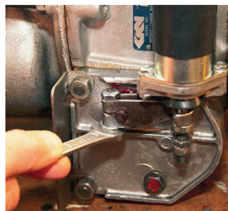
25 ... anslut solenoiden till ett batteri. När solenoiden står i hållläget justerar man hävarmen så att den vilar mot huvudet på solenoidens dragstång och drar fast klämskraven.
