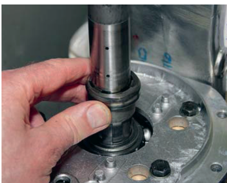
22 Glöm inte excentern som driver överväxelns pump innan du monterar ihop överväxel och växellåda.
