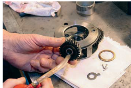
11 Att pressa dit det nya nållagret är enkelt eftersom det är ett kapslat lager. Se bara till så att det inte kantrar och kommer snett när du pressar dit det.
