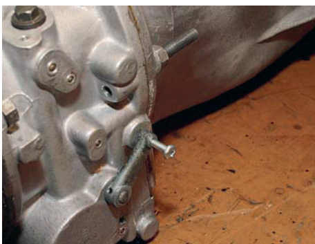
24 När solenoiden är monterad ska hydraularmen som manövrerar överväxeln justeras. För in en borrar eller en skruv som är 3/16 tum genom hålet i armen och in i motsvarande hål i huset och ...
