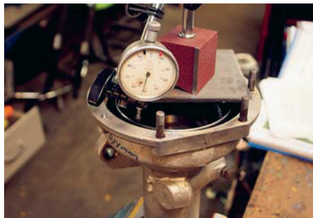
8 Avsluta med att kontrollera att axialspelet blev det rätta trots nya lager.
