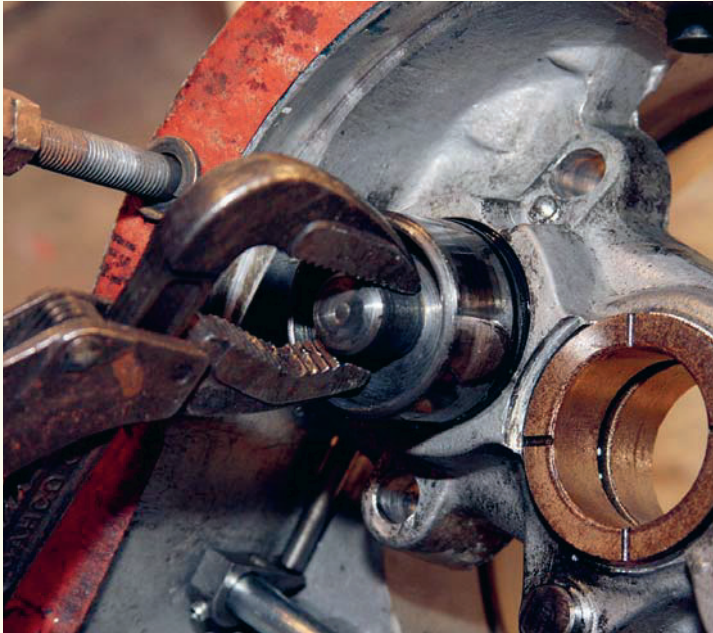
5 Kolvarna som kopplar in överväxeln tar man enklast bort med hjälp av en polygrip.
