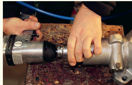
12 Enklaste sättet att lossa muttern till kardanaxelns medbringare är med hjälp av en luftdriven mutterknack.
