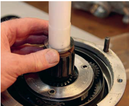
24 Montera planetväxeln, linjera upp växeln och frihjulsnävet med hjälp av axeln du har tillverkat och lägg på justerbrickan i stål och bronsbrickan ovanpå solhjulet.
