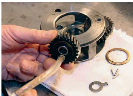
12 Smörj det nya lagret och axeln ...
