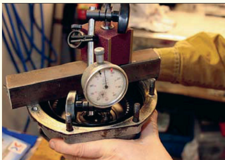
11 Mät utgående axelns axialspele med en indikator-klocka innan du demonterar den.
