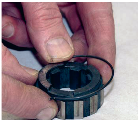
16 Börja med att montera fjädern som håller ihop navet och rullhållaren och montera sedan ...
