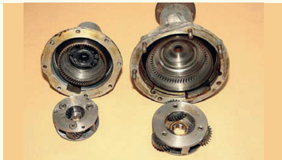
8 Till vänster planethjul och ringhjul från en D-typ och till höger från den större A-typen. Frihjulsnävet i D-typens centrum har verkligen sett sina bästa dagar. Antagligen har någon försökt att backa samtidigt som överväxeln varit inkopplad.
