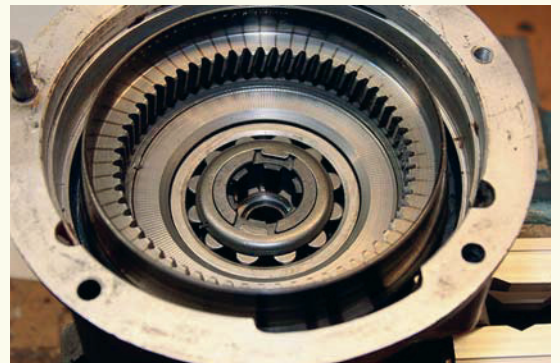
9 När man har lyft ut planethjulen och hållaren ur ringhjulet hittar man frihjulet som när man har lyft ut det ...
