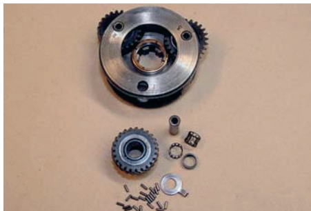
10 Efter att axeln är borttagen är det bara att lyfta ut planethjulet och då faller i stort sett nållagret ut ur hjulet av sig självt. När du byter lager, byt också den lilla axialbrickan som ligger under varje planetjul.
