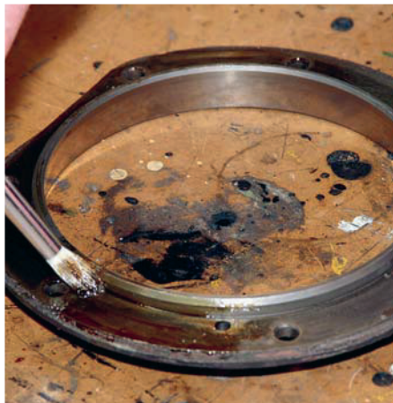
22 Pensla på packningsklister på bromsringen och montera den sedan på ...
