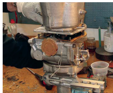
23 På en A-typ med lösa fjädrar är det enkelt att montera överväxeln i ett skruvstycke och sedan ställa växellådan ovanpå överväxeln. Dels behöver man inte hålla ordning på fjädrarna, dels hjälper växellådans tyngd till vid monteringen.
