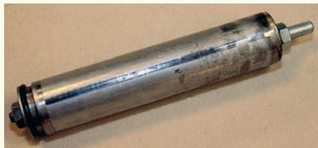
12 Den färdiga avdragaren. Man pressar in O-ringen i ackumulatorm, skruvar åt muttern till höger i bild så att O-ringen kläms ihop mellan brickan längst till vänster och det yttre röret och expanderar och på så sätt håller fast verktyget i ackumulatorm. Sedan är det bara att hoppas att ackumulatorm följer med ut när man lirkar ut verktyget.
