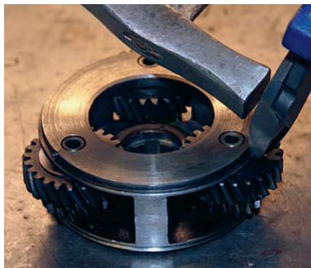
9 För att byta lager i planethjulen börjar man med att ta bort låspinne som håller fast axeln planethjulet är lagrad på.
