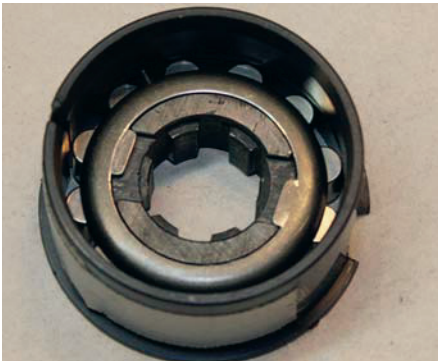
18 Använd ett rör eller en gummisnodd för att hålla rullarna i lagret på plats och montera rulle för rulle i lagret.
