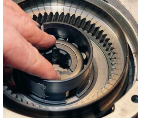
20 ... skjuter ned lagret i uttaget i utgående axeln.
