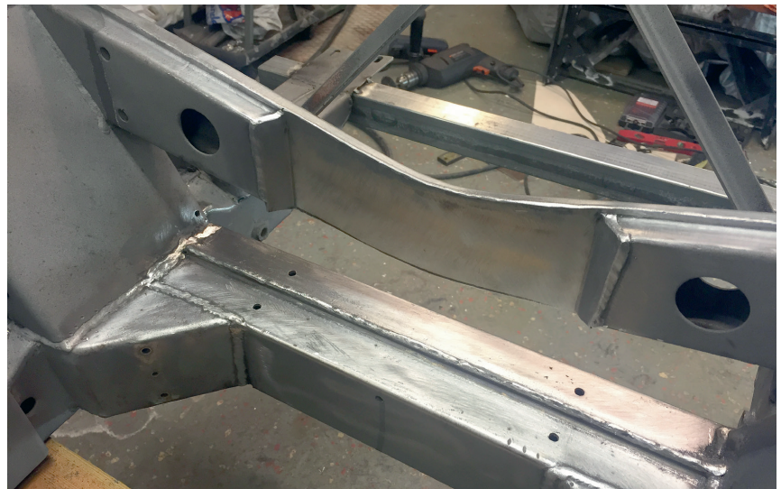
"Urgröpfung" av främre övre tvärbalk. Underlättar när motor ska i eller ur.
