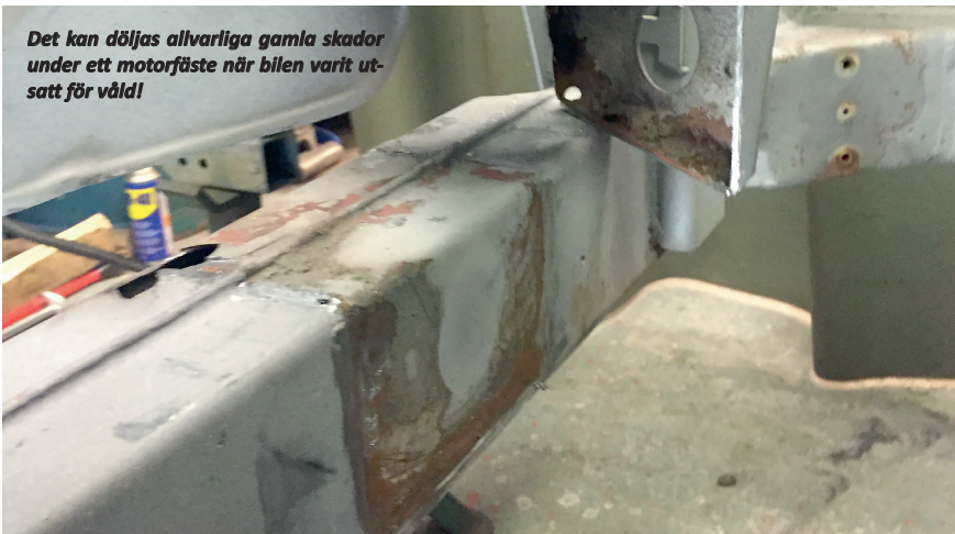
Och det framträder än tydligare efter lite slipning – både sprickor och hål.
