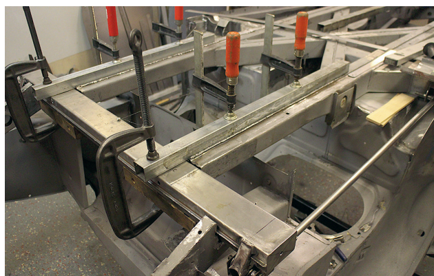
Nedan: Bakre tvärbalk fixerad inför svetsning.
