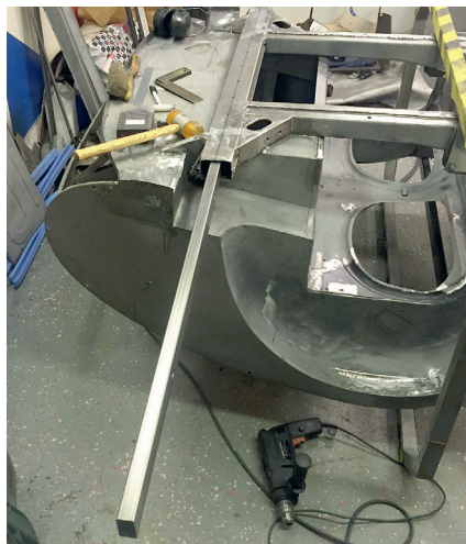
Förstärkningsrör slås in
