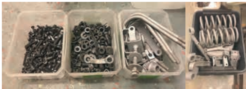
Sorterade delar som ska förzinkas efter rensning av gängor och blåstrats eller legat i Annitrol två dygn.
