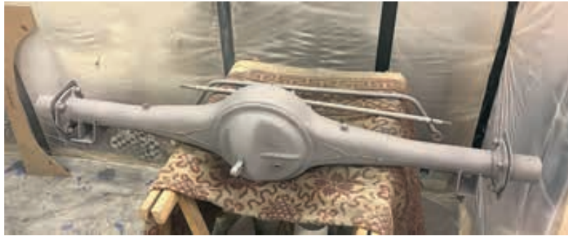
Att blåstra är kul! Man ser skillnaden direkt – är som att lackera med grå färg. Bara all underredsmassa och liknande är borta först!
