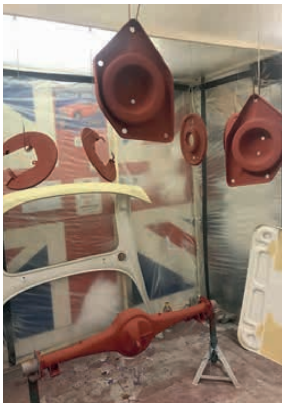
Lackboxen till ständig nytta. Här med grundmålade chassidetaljer.
