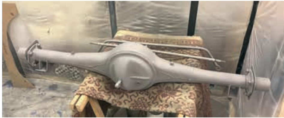
Att blåstra är kull! Man ser skillnaden direkt – är som att lackera med grå färg. Bara all underredsmassa och liknande är borta först!
