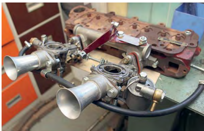
Förgasare under renovering (men undrar om det fungerar med öppna trattar när kulingen slår till?)
