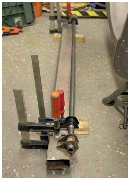
Bakre fjäderfästen fixerade inför svetsning
