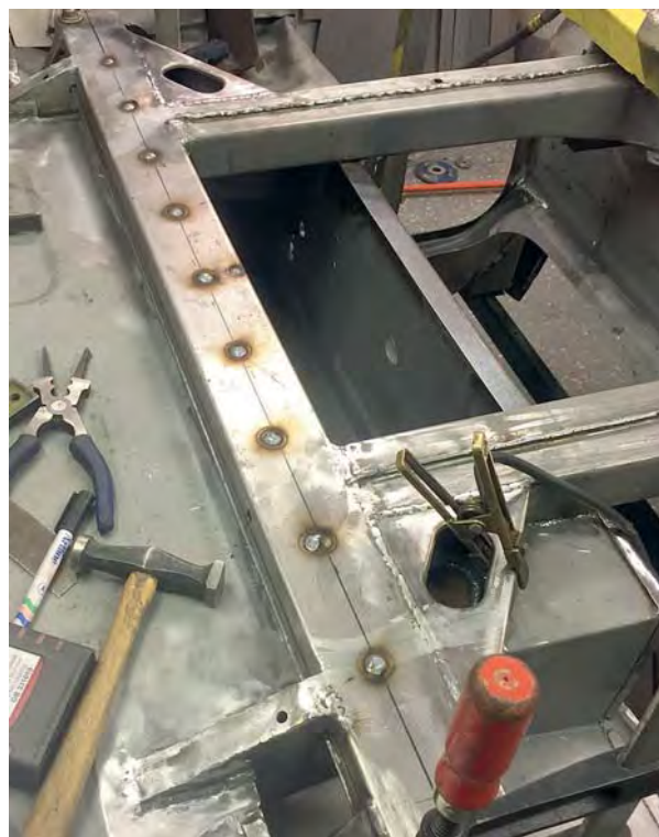
Förstärkningsrör på plats (ovan) Och svetsat! (nedan)
