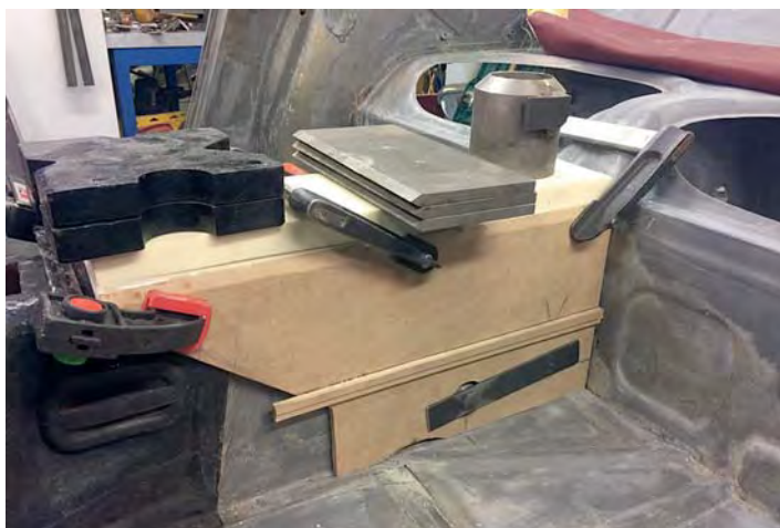
Tillverkning av plugg till nytt armstöd. Först lite snickarjobb ...
