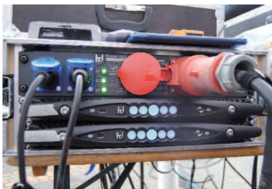
Eine Powersoft X4 Endstufe treibt das hd HLS20-TourSys1 an
