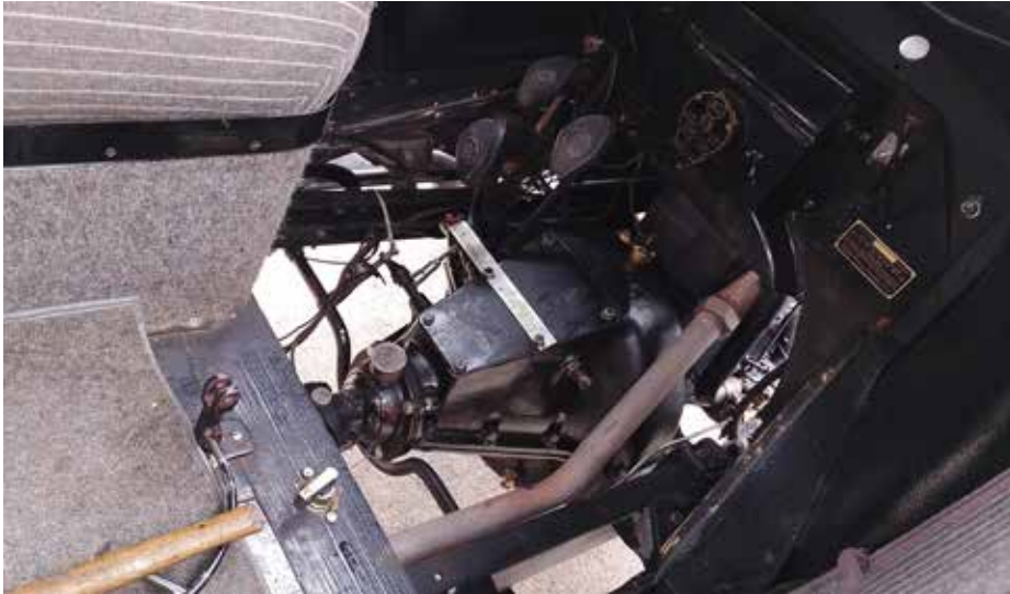
Passagerarsätet är uttaget golvbrädorna bortlyfta, och det är bara att åla in och skruva av locket på växellådan (mitt i bilden)
