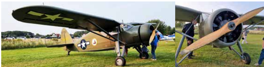
SE-AWS, Fairchild F24W-41A Forwarder. Tillverkad 1943. 8-cylindrig stjärnmotor, träpropeller
