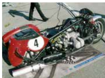
Sidvagnsekipagechassit, en gång i tiden tillverkat av Janne Svedel som förr var en duktig burkslav. Motorn är en rejält trimmad BMW R75 750cc. Den kördes av Magnus Martebo med burkslav Karin Gustavsson
