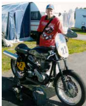
Jag inne i depån och kollar ett riktigt specialbygge som kallas Norvin, Norton ram, tank m.m. Vevhus modifierat från Monark Albin, cylinder topplock mm. Specialmotorn på 500 cc
