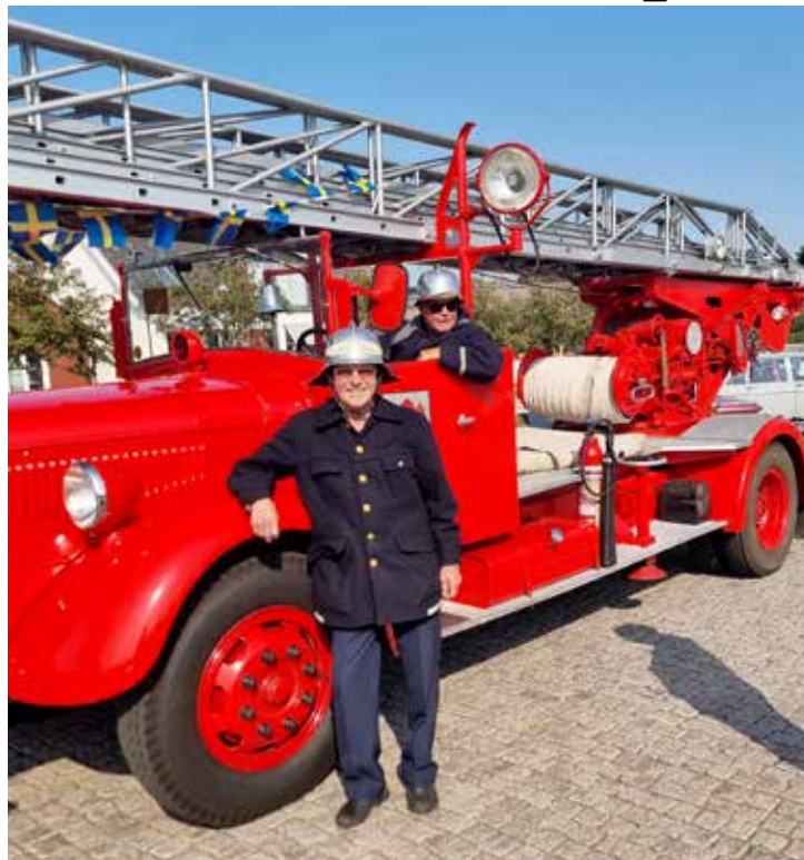
Volvo med hydramekanisk maskinstege från 1937. Stegen är på 26+2 meter. Avställdes 1985
