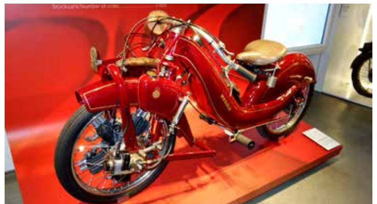
Megola Sport 1922-1925. En udda motorcykel med en väldigt ovanlig motorplacering. Inne i framhjulet sitter en 5-cylindrig 4-taktsmotor på 640 cc och växellåda. Undrar hur den är att köra.
