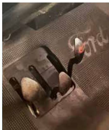
Pedalstället i en Ford T ser inte riktigt bekant ut för en moderna chaufför. Från vänster: växelpedal, backväxel, fotbroms
