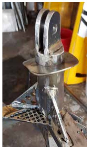
Förstärkning/förstyvning av chassit som Anders gjort under återuppbyggnaden
