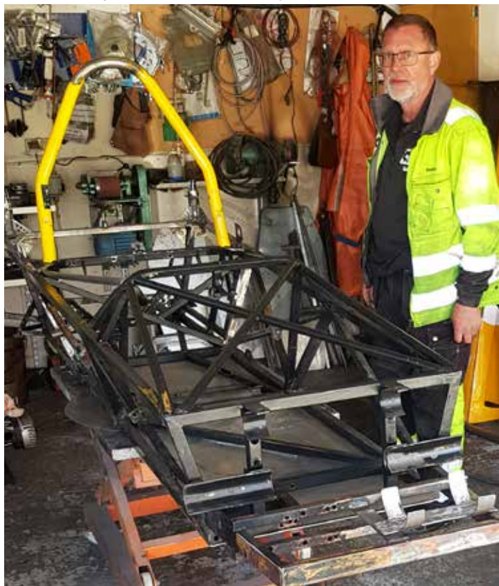
Anders bredvid chassit till sin formel Vee. Efter kraschen i Falkenberg i september 2022 blev det mycket svetsande
