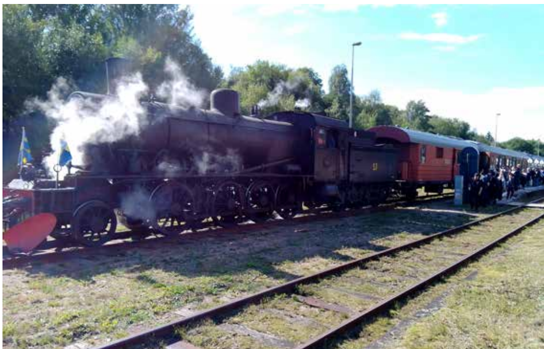
Ånglok : SJ littera E2 nr 1092. Ångloket är byggt 1911 av Vagn och Maskinfabriken i Falun. Loket ägs av Nässjö järnvägmuseum. Tjänstevikt 91 ton. Vattenförråd 14 kubikmeter. kolförråd 5,2 ton. Källa : från tågdagarnas programblad.
