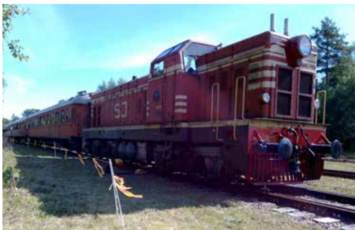
Diesellok : SJ littera T 41 200. Byggt av Noab i Trollhättan på licens av General motors 1956. Loket står på Nässjö järnvägmuseum. Dieselelektriskt. Effekt 1065 kw. Tjänstevikt 84 ton.
