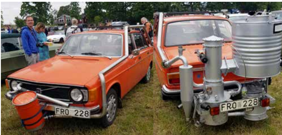
På parkeringen i Odensjö stod en Volvo 144 från 1973 konverterad till gengasdrift. Något klumpigt verkar det nog?
