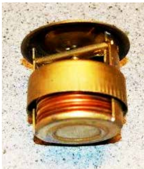
Korrekt termostat för BMC-bilar
