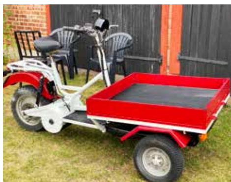
Norsjö Carrier Electric 2006. Drivs med elmotor på 4 hk
