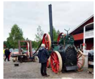
Ångmaskinen, en lokomobil, drog en kombinerad såg och vedklyv. Sågade stockar och hade två klyvar.
