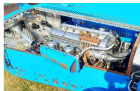
Bugatti är försedd med Jaguars XK-motor
