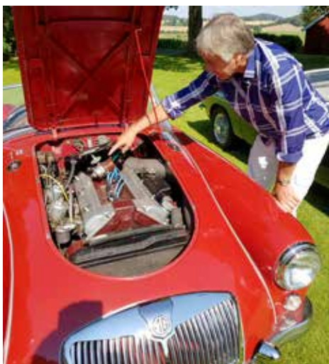
Fördelardosan är uppflyttad på Thomas MGA och sitter direkt på kamaxeln
